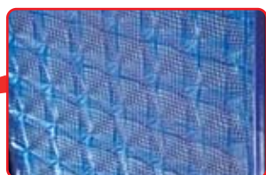
объемная структура фильтра (3D)
