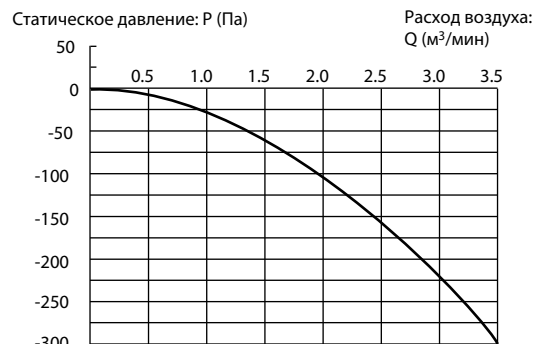
Расход приточного воздуха (подача воздуха в блок)
